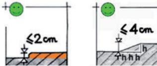
Si la marche est supérieure à 4 cm, l'entrée doit être équipée d'une rampe permanente avec un palier de repos horizontal devant la porte.
