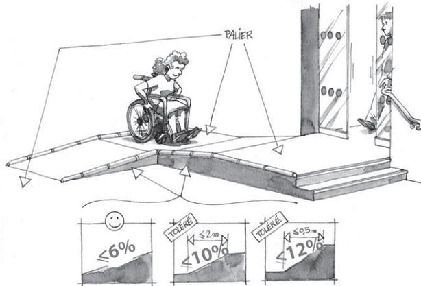
**LA PORTE D'ENTREE** s'ouvre facilement et le passage utile est de 0,77m minimum.
